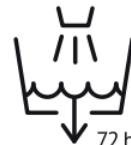
Zbiornik na wodę należy opróżnić i ponownie napełnić co trzy dni. Przed napełnieniem wyczyścić wodą z wodociągu lub środkami do utrzymania czystości, jeżeli tego wymaga producent. Usuń osad z kamienia lub powłokę, która pojawiła się na ścianach i rowach lub na powierzchniach wewnętrznych, wszystkie powierzchnie wytrzyj do sucha.
